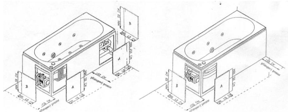
**POZOR !!!** před vytvořením těchto otvorů je třeba vycházet ze skutečnosti umístění agregátů u Vámi zvoleného typu hydromasážní vany.
