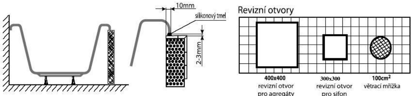
Příklad umístění montážních otvorů u hydromasážních van s jedním a dvěma agregáty
